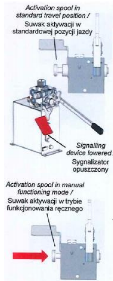
Rysunek 33 Usunięcie funkcji hamulca automatycznego
