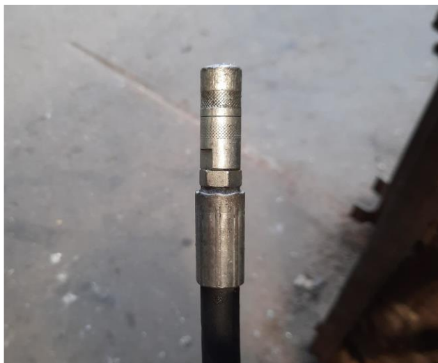
Do smarowania wału najodpowiedniejsza jest powyższy króciec smarownicy.
