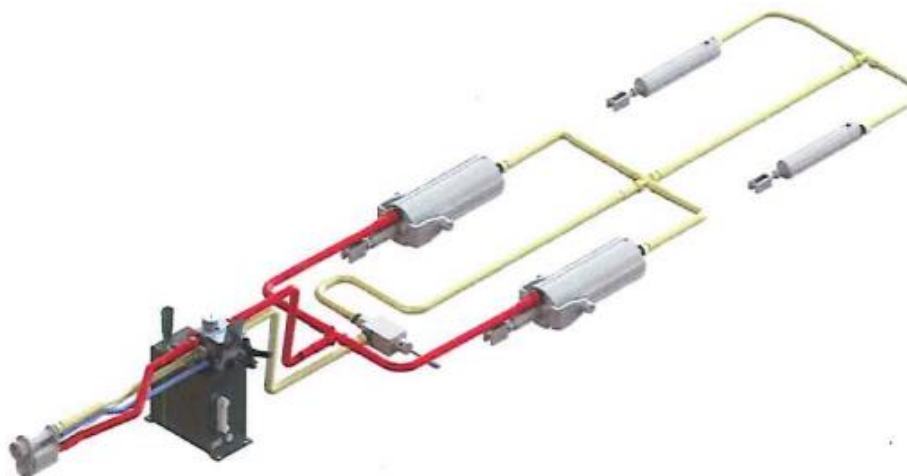
Rys.5 Widok poglądowy dwuliniowego układu hydraulicznego systemu hamulcowego.
