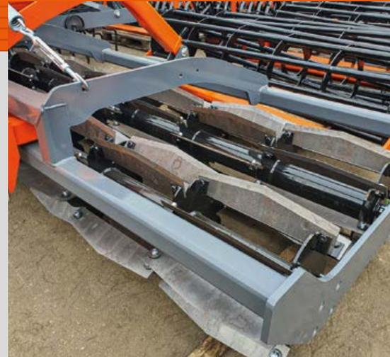
Die **TANDEM MESSERWALZE** ist eine Maschine, die für das intensive Zerkleinern von Pflanzenmasse (Stroh, Ernterückstände, Stopplern, Zwischenfrüchte) sowie das Quetschen und teilweise Bedecken konzipiert ist. Dies beschleunigt den Abbau der Rückstände und fördert den weiteren Arbeiten bei der Bodenbearbeitung. Die Arbeitstiefe der Maschine beträgt 2-3 cm (Messereintauchtiefe).
