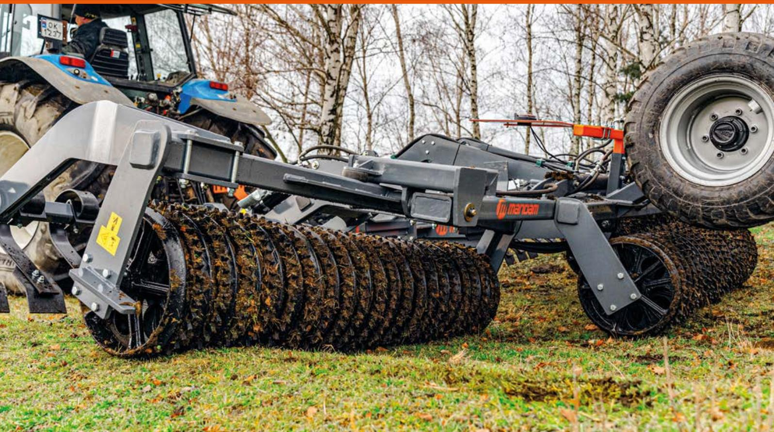
Die SWING-Version der angebotenen Cambridge-Walzen zeichnet sich durch seitlich schwenkbare Sektionen aus, die eine bessere Anpassung an Unebenheiten auf dem Feld ermöglichen. Die SWING-Version der angebotenen Cambridge-Walzen zeichnet sich durch seitlich schwenkbare Sektionen aus, die eine bessere Anpassung an Unebenheiten auf dem Feld ermöglichen.
