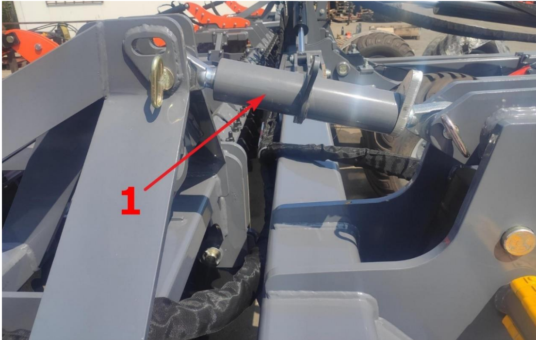
Rys. 25 Umieszczenie śruby rzymskiej na zespole dyszla; 1-śruba rzymska.
