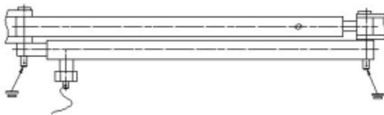
Rysunek 8 Instrukcja postępowania podczas montowania nowej blokady mechanicznej siłownika
