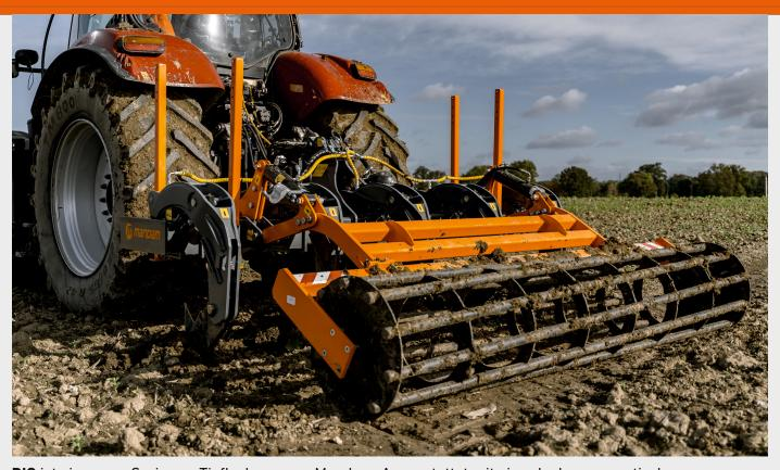
**DIG** ist eine neue Serie von Tieflockerer von Mandam. Ausgestattet mit einer hydropneumatischen Non-Stop-Zinkensicherung, garantieren sie einen effizienten Betrieb unter schwierigen Bedingungen. Sowohl der Sicherungmechanismus als auch das Arbeitssystem selbst stammen vom erfolgreichen Meißelpflug Mandam GROT.
