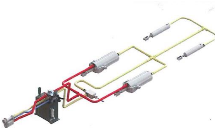
Rysunek 5. Widok poglądowy dwulinowego układu hydraulicznego systemu hamulcowego
