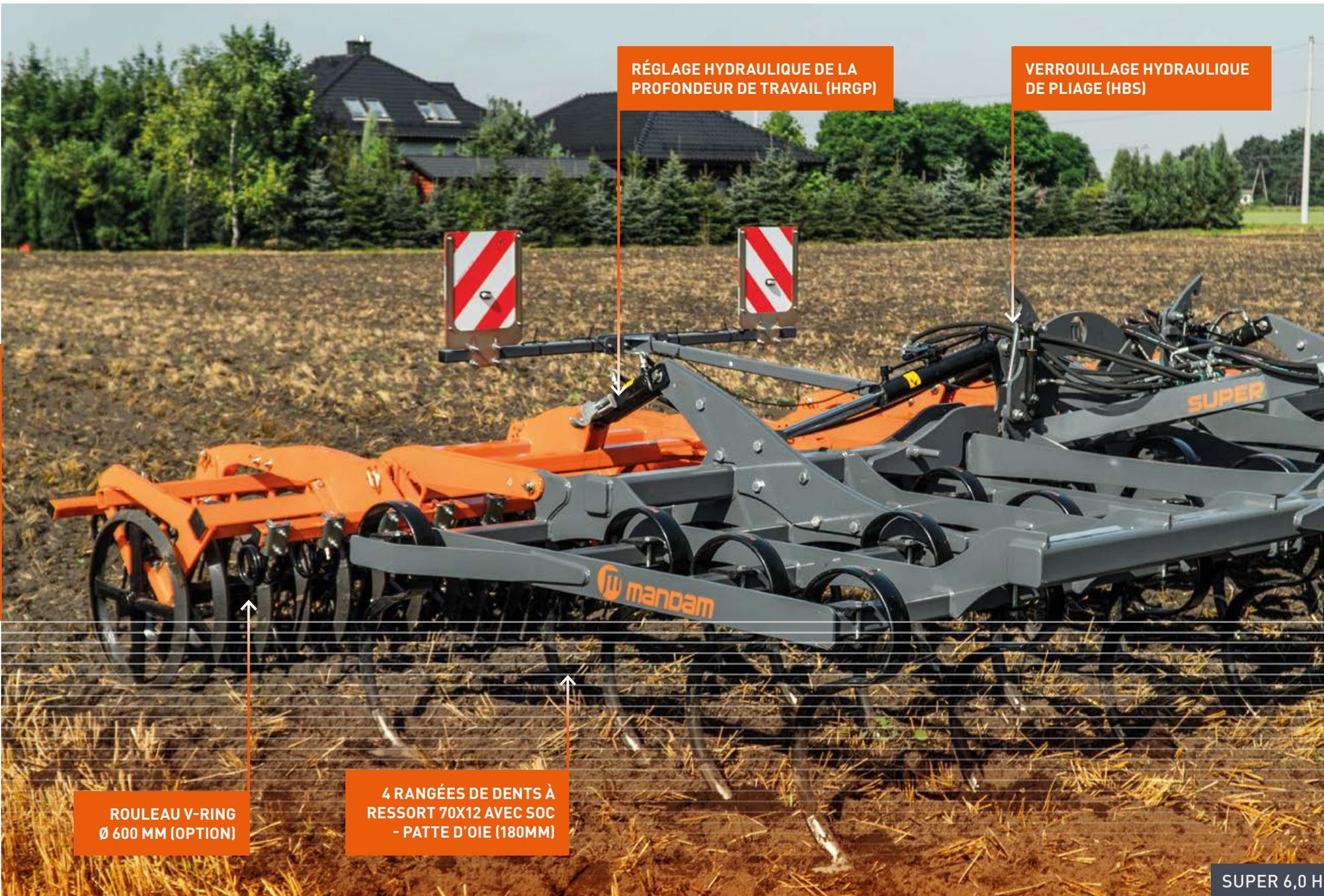
RÉGLAGE HYDRAULIQUE DE LA PROFONDEUR DE TRAVAIL (HRGP)
