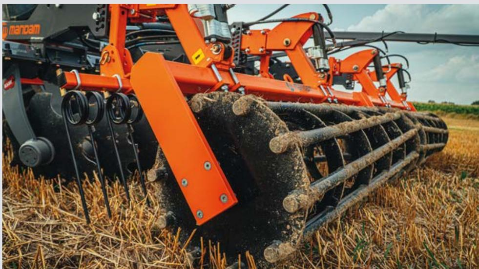
Nivelle le sol avant le rouleau, grâce à quoi le rouleau roule sur une surface plane et ne provoque pas de vibrations supplémentaires de la machine. Recommandé pour les cultures de pré-semis.
