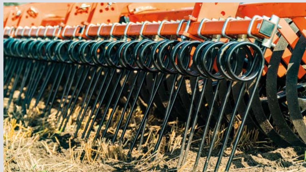
Reconsolide et nivelle le sol derrière la machine, recommandé pour les cultures de pré-semis.
