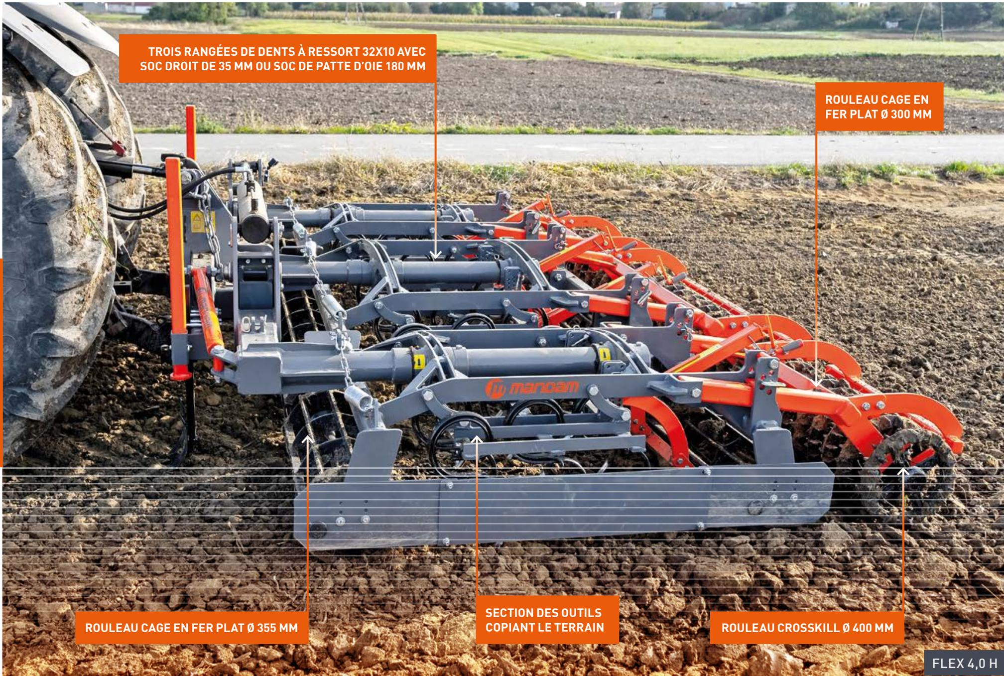
TROIS RANGÉES DE DENTS À RESSORT 32X10 AVEC SOC DROIT DE 35 MM OU SOC DE PATTE D'OIE 180 MM
