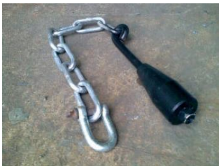
Fig. 4 Un boulet draineur – une charge à chaîne.
