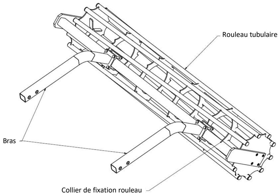
Fig. 3 Raccordement des bras à la fixation du rouleau.
