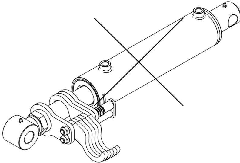
Fig. 12 Installation incorrecte des cliquets sur la tige du piston du vérin. L'omission partielle de la fixation des cliquets à l'actionneur entraîne une répartition inégale des forces agissant sur la tige du piston et peut conduire à un flambage de la tige du piston et endommager l'ensemble du vérin. Une telle installation des cliquets est inadmissible!
