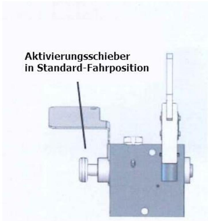
Abb. 11 Standardposition des Aktivierungsschiebers in der Fahrposition.
