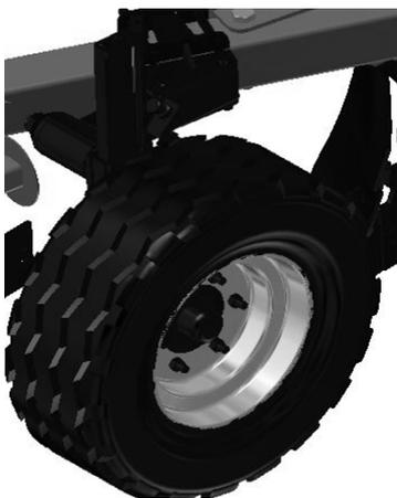
Sorgt für die Beibehaltung der Arbeitstiefe und die Bodenkopierung auf eine Weise, so dass eine gleichmäßige Arbeitstiefe unabhängig von seinen Unebenheiten erreicht wird.
