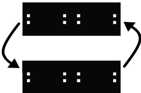
Kufen, die an ihren Spitzen bis auf 5 mm abgenutzt sind, können gedreht werden, um ihre Lebensdauer zu verlängern. Dazu die gelösten Kufen um 180° drehen. Anschließend werden die Kufen von den linken Pflugkörpern auf die rechten Pflugkörper und umgekehrt übertragen, wie in der Abb. gezeigt.
