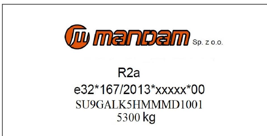
Rys. 3 Tabliczki znamionowa brony talerzowej BTH.
