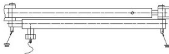
Rys. 6 Sposób mocowania teleskopu zabezpieczającego
