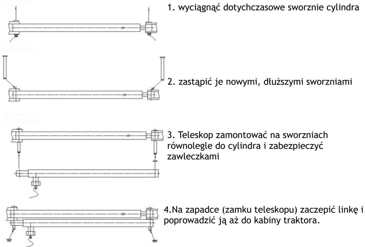
Rys. 5 Sposób mocowania zabezpieczenia
