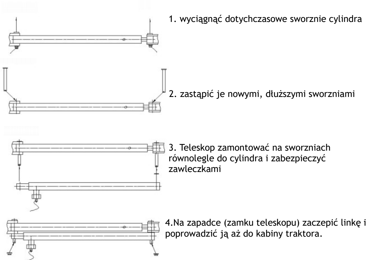
Rys. 4 Sposób mocowania zabezpieczenia
