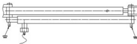
Rys. 6 Sposób mocowania teleskopu zabezpieczającego
