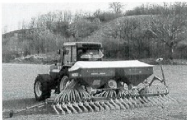
rys. 13 Siewnik MPS 6 szerokość robocza 6m
