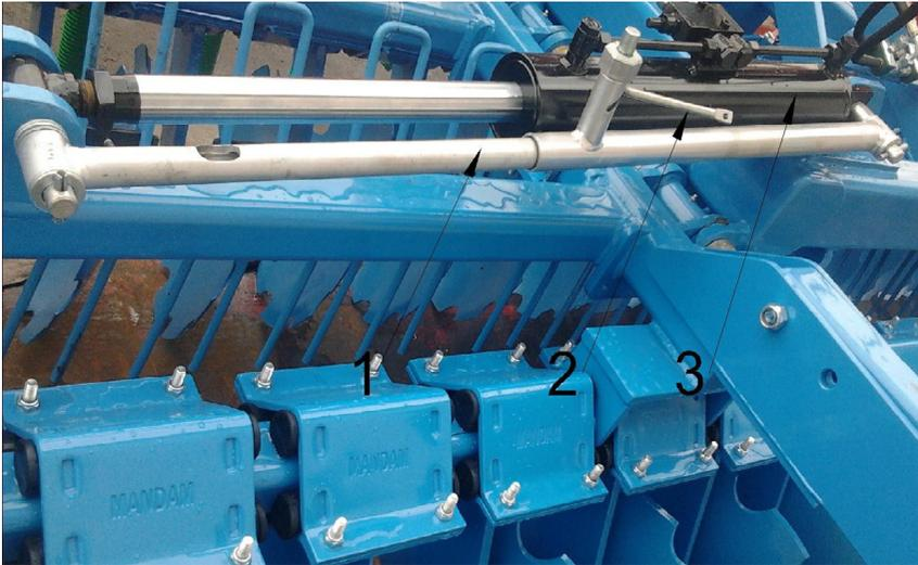
Dib. 2 Bloqueo mecánico GAL-C: 1 - protección mecánica, 2 - brazo del bloqueo que se tira con cuerda
