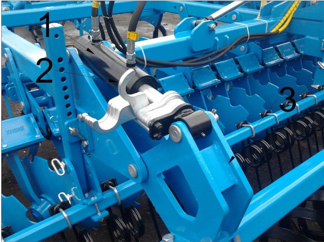
Abb. 8 Hydraulische Tiefenregelung der Walze 1 – Servomotor, 2 – Sperrklinke zum Regeln der Betriebstiefe, 3 – Trägerarm der Walze
