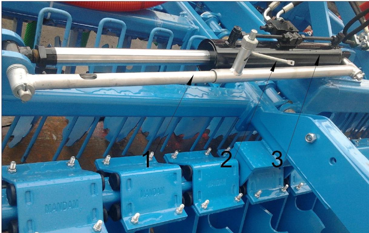
Abb. 3 Mechanische Blockade des TAL-C: 1 - mechanische Schutzeinrichtung, 2 - Arm der Blockade, an dem mit einer Schnur gezogen wird; 3-Servomotor
